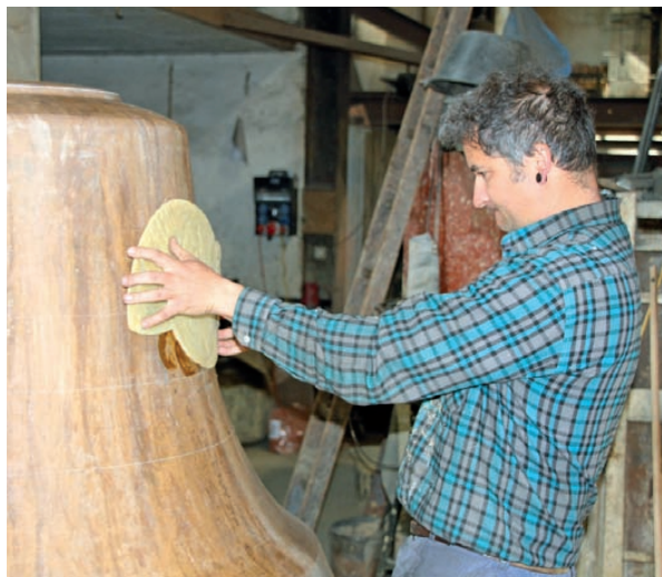
Die in Bienenwachs gegossene Verzierung wurde sorgfältig auf die Glockenform geklebt und mit einer weiteren Lehmschicht an Ort fixiert.
