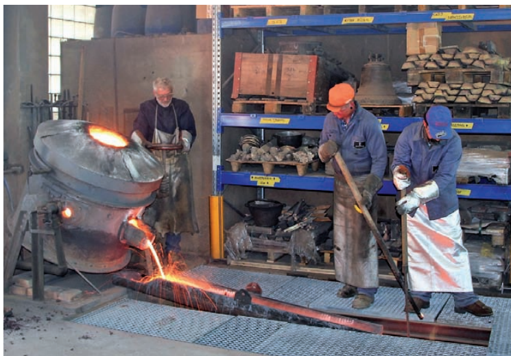
In einem rot glühenden Bächlein floss die sogenannte «Glockenspeise» durch einen kleinen Kanal zu der im Boden versenkten Gussform.
