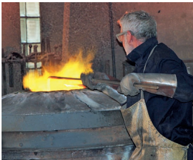
Am Gusstag wurde die Glockenbronze aus 79 Prozent Kupfer und 21 Prozent Zinn im Schmelzofen auf über 1000 Grad erhitzt.
