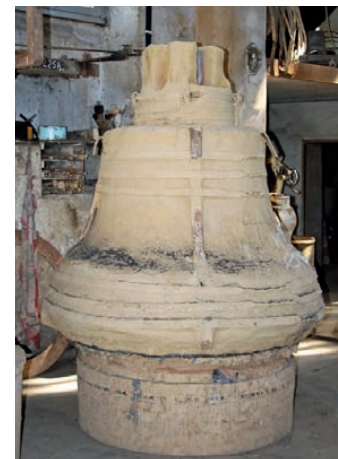
Im nächsten Arbeitsschritt bekam die Glockenform einen Mantel, der mit Hanffasern und Eisen armiert ist, um den grossen Kräften beim Guss standzuhalten.
